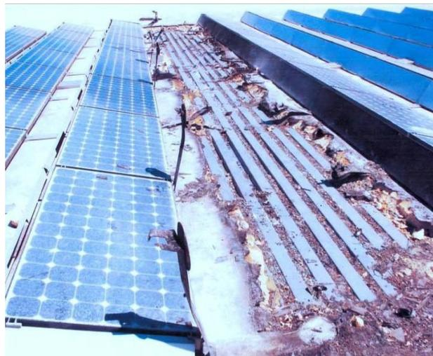
图 3.6-1 光伏屋顶的太阳能组件“自燃” 图 3.6-2 屋顶太阳能光伏电站“自燃”现场
